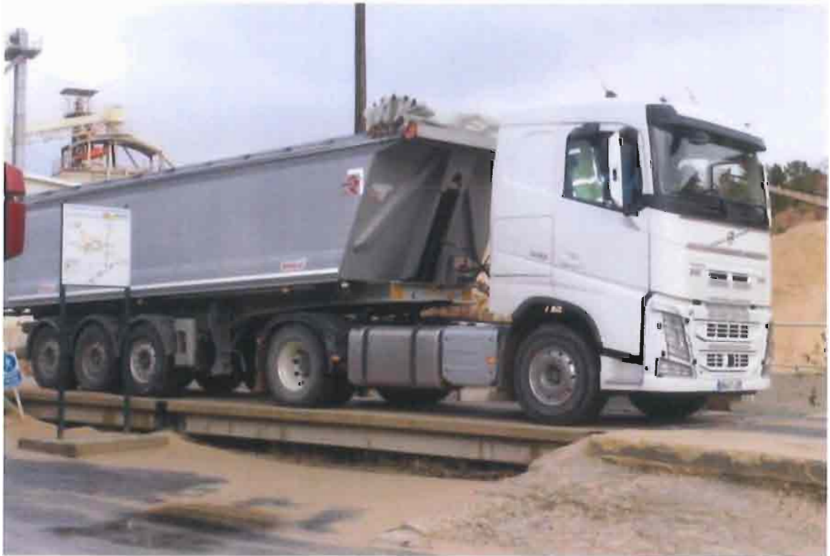
Camion benne au pont bascule (la bâche est repliée sur l'avant de la remorque).
